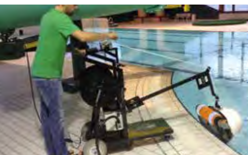
Si le rebord de la piscine possède une margelle, nous avons un chariot potence permettant d'extraire la machine sans effort.
