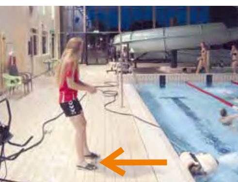
Le robot peut être sorti de l'eau sans effort grâce à la drisse fixée sur le robot et à l'aide de la radiocommande.
